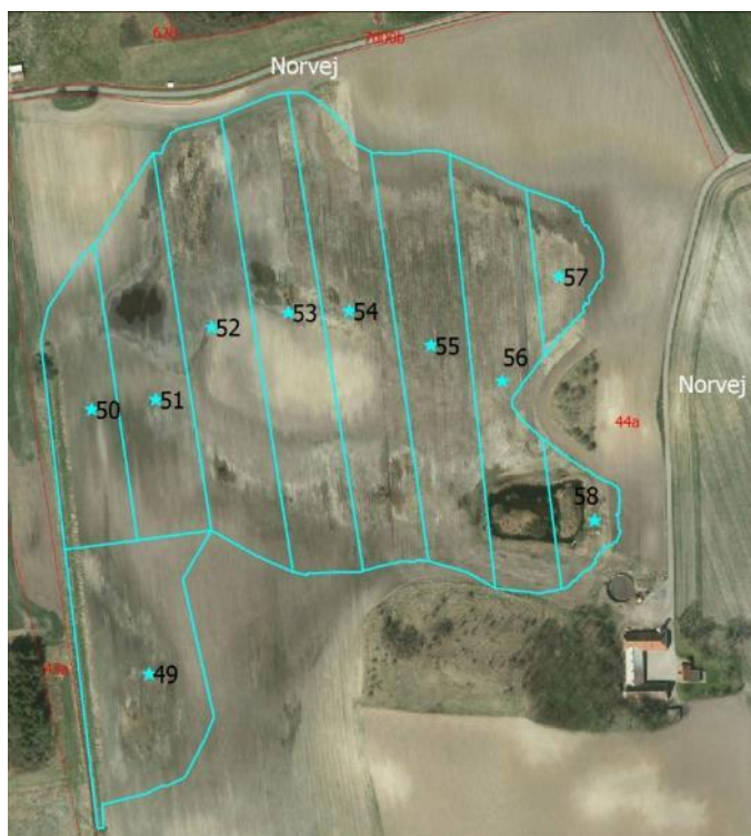
Figur 8: Prøvefelter (lys blå streg) til udtagning af jordprøver til fosforanalyser. Lys blå stjerne angiver lokalitet for udtagning af prøver til bestemmelse af volumenvægt og jordbundsbeskrivelse.
